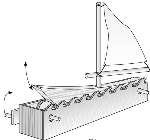
☞ Puedes sustituir la manivela por un molino de viento que producirá un mayor movimiento del barco cuanto más viento exista.
