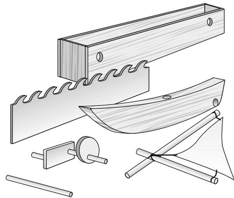
☞ Construye la rueda excéntrica con el mismo material que la silueta del barco. Prepara un eje con una manivela en su extremo. Une el eje y la excéntrica y colócalos en el bastidor por debajo del barco.
